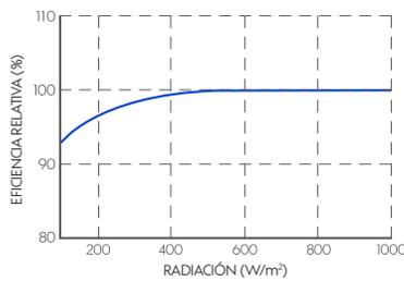
Rendimiento típico del módulo en condiciones de baja irradiación en comparación con las condiciones STC (25 °C, 1000 W/m²).
